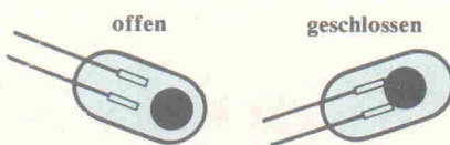
Bild 2. Die möglichen Schaltzustände von Quecksilberschaltern.
